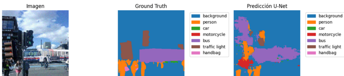
Figura 3.13: Primera visualización de la inferencia de la red U-Net sobre una imagen del conjunto de test frente a su ground truth.
