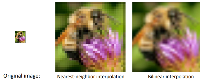
Figura 2.6: Diferencias en los resultados al aplicar upsampling mediante Nearest-Neighbor e interpolación bilineal sobre una misma imagen de baja resolución. Obtenida en [31]
