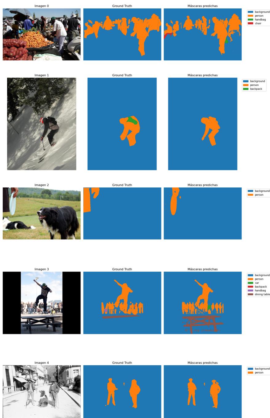
Figura 3.18: Resultado de la inferencia de la arquitectura compuesta por RetinaNet y SAM sobre las primeras muestras del conjunto de datos
